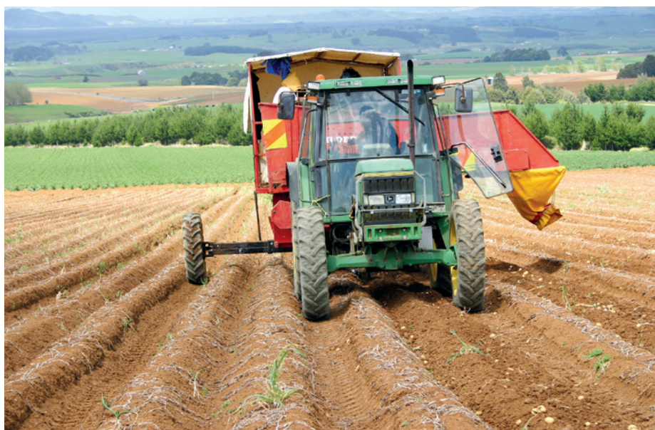
1,83 METER BREDE BEDE - En kartoffeloptager ved Wilcox i New Zealand er ombygget, så den passer til bedene. Under transport skubbes det yderste hjul ind. Foto: Dan Bloomer, Landwise.
